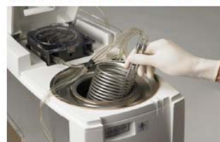
スタートアップキット (ステンレスコイル、チューブ、エアトラップなど)
